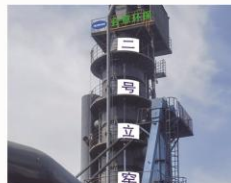
新疆天业立式烘干窑及配套脱硝除尘系统
